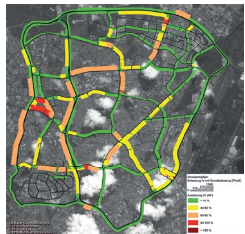
Abbildung 5: Simulation einer Steuerungs- variante für ein Teilnetz von Singapur.
